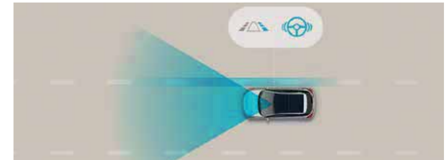
Lane Keep Assist (LKA) Lorsque l'Assistance active de Maintien de Trajectoire remarque que votre voiture quitte sa bande de circulation, elle vous prévient ou modifie activement la trajectoire pour maintenir le véhicule sur sa bande.
